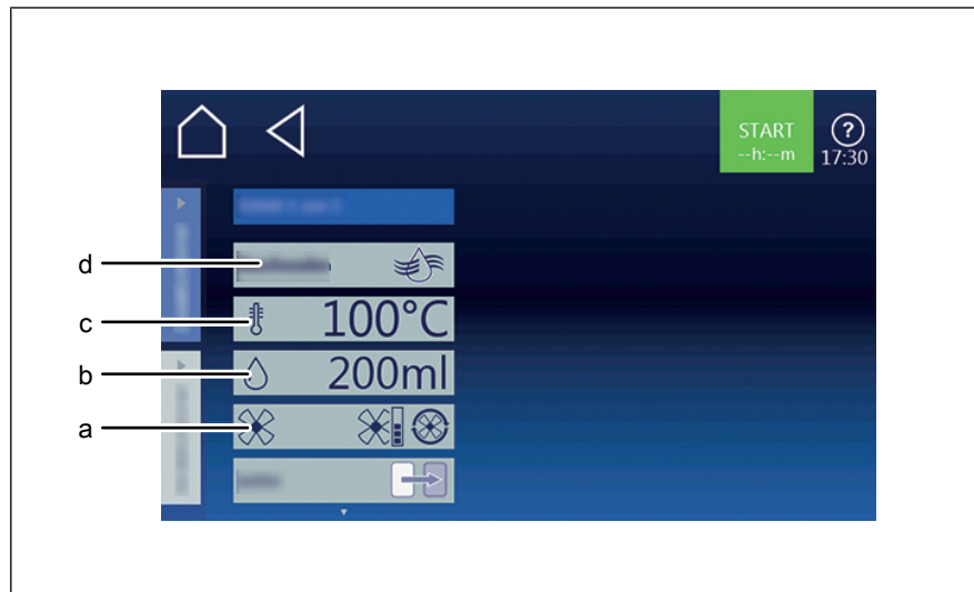
Figur: Vinduet Indstilling manuel dampinjektion
